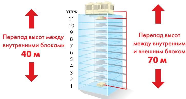
SMMS-i опережает конкурентов по максимально допустимому перепаду высот между внутренними блоками. Он может достигать 40 метров! Одна VRF-система Toshiba SMMS-i способна полностью кондиционировать 11-этажное здание.
